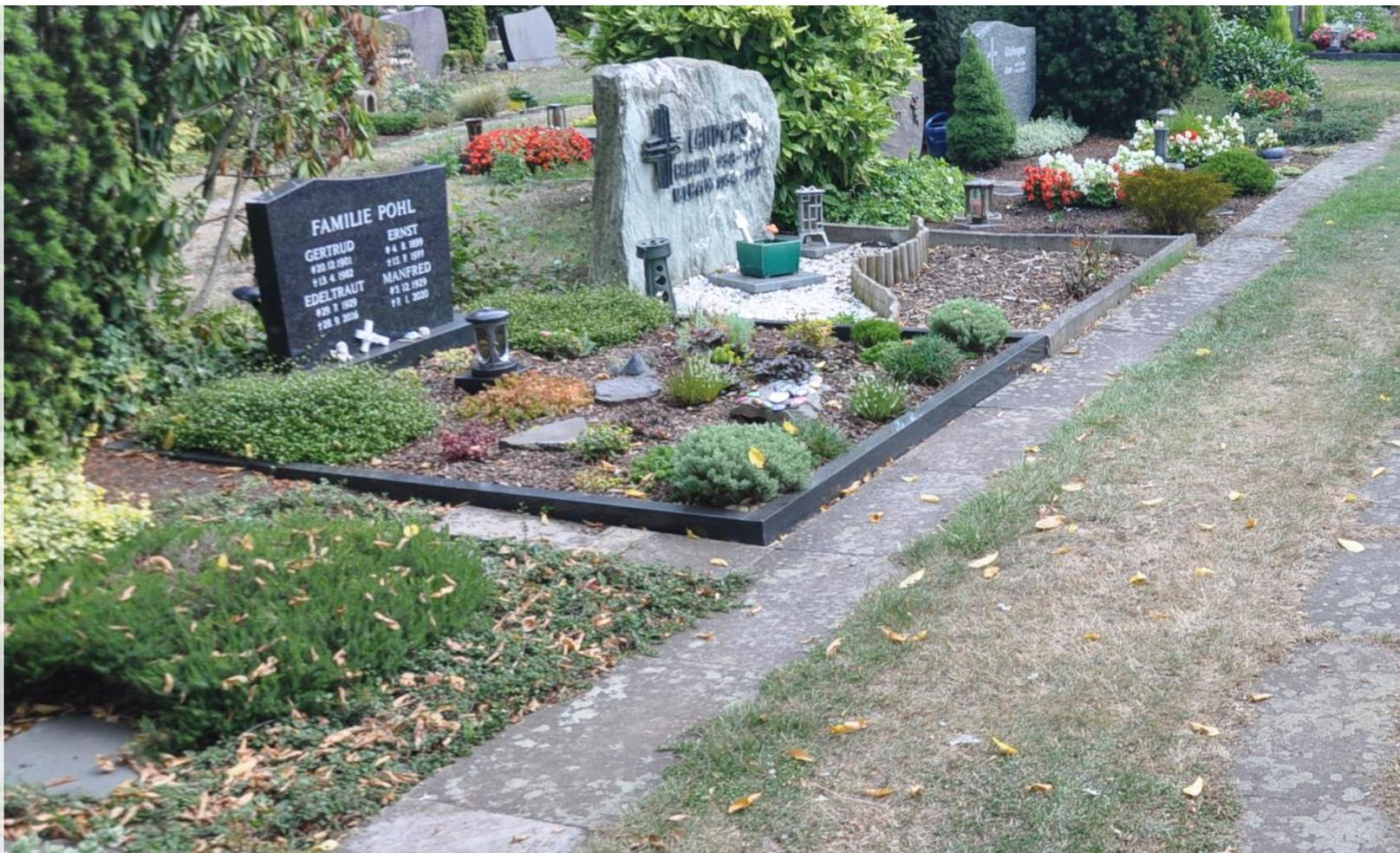
Die Pflege der wassergebundenen Oberflächen ist aufwändig, weshalb das absichtsvolle Vergrünen eine gute Methode ist, Aufwand zu reduzieren. Die Wege müssen anschließend nicht mehr von Unkraut befreit, sondern können regelmäßig gemäht werden. Auf gute Begehbarkeit ist weiterhin zu achten. Die Platten dienen in diesem Fall unabsichtlich als Mähkante, müssten aber entfernt werden, wenn sie sich werfen sollten.
